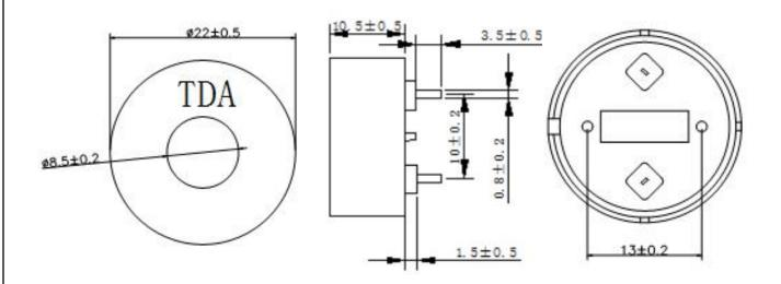
Unit:mm Tolerance :  $\pm 0.5$ mm
