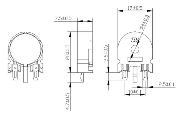
Unit:mm Tolerance :  $\pm$ 0.5mm
