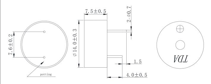
Unit:mm Tolerance :  $\pm$ 0.5mm
